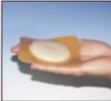
*Eine Hautplatte wird auf ein Glas Wasser geklebt und umgedreht. Die rechte Abbildung zeigt an, dass eine Klebeschicht ohne Elastomere viel Feuchtigkeit aufnehmen kann. Diese Eigenschaft ist für eine Hautplatte wichtiger als Elastizität.*
